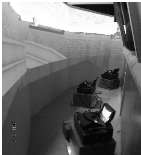
Rys.3. Sposób obrazowania obrazu panoramicznego na ekranach segmentowych Fig.3. Imagery panoramic image on the screen segment
