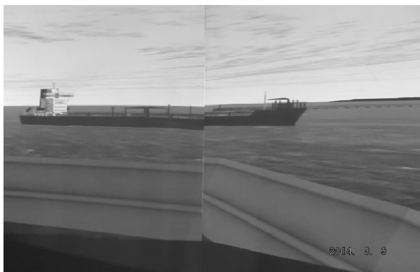
Rys.4. Problem poprawnego dopasowania wyświetlanego obrazu na styku połączenia dwóch rzutników Fig. 4. The problem of the correct matching of the projected image at the junction of the combination of two projectors
